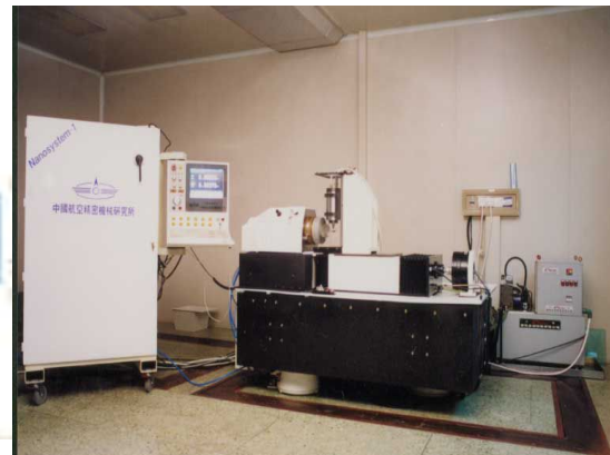
非球面超精密车床 (北京航空精密机械研究所) 2001年
